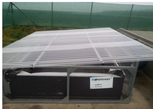
Plato za ispiranje prskalice i Heliosec u kom se sakuplja otpadna voda
